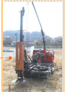
動的コーン貫入試験(N値) <ラムサンディング>
